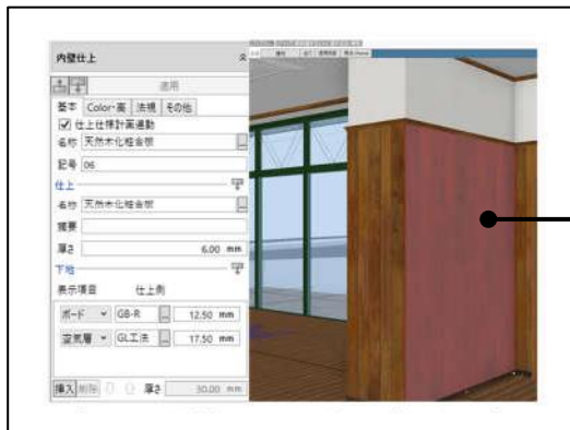
■BIM モデルの各部屋には仕上情報を登録できる。それを基に仕上表を自動生成できる。
