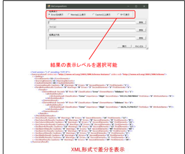
■解析モデルと構造モデルの双方から出力したST-Bridge※2 ファイルを比較ツールを用いて断面の確認を行う。
