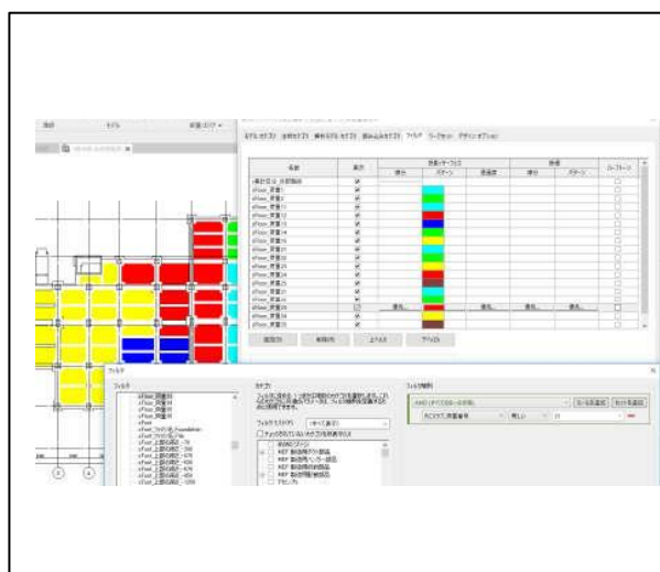
■ 構造伏図に床荷重毎の色分けを行うことで荷重配置図を作成。同様の着色を平面図に行い、両者を比較することで整合性の確認が可能。
