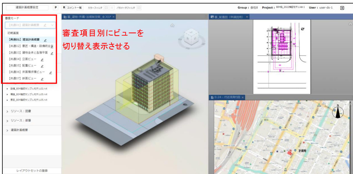
図13－BIMビューアの主な機能「2. 審査項目別にビューを指定する」の紹介 (提供：建築研究所)
