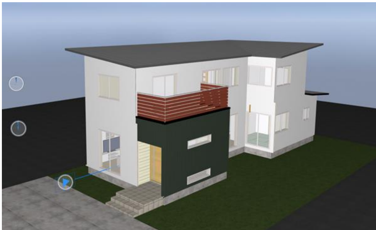
図6一戸建住宅サンプルモデル パース Archicad で作成・BIMxで表示した BIM モデル外観(意匠)
