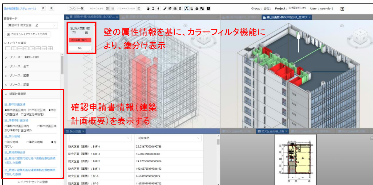
図14－BIMビューアの主な機能「4. 属性情報を可視化するためのカラーフィルタ(塗分け凡例)」のビュー画面(提供：建築研究所)
