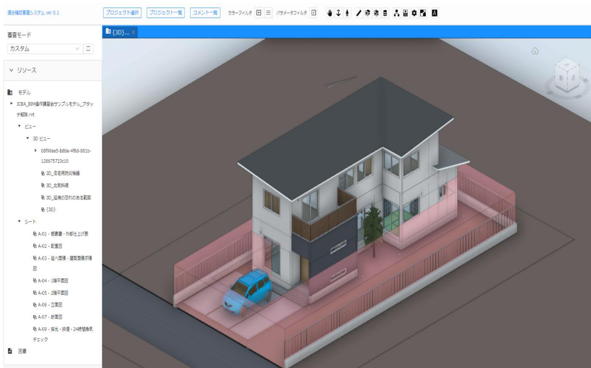
図3－延焼の恐れのある部分の外観①
