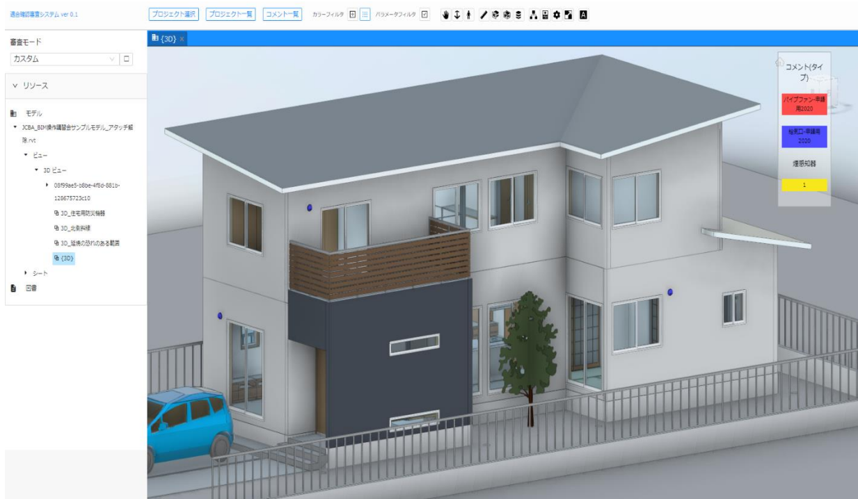
図10-24 時間換気用給気口、排気機をカラーフィルタにて色塗り表示
