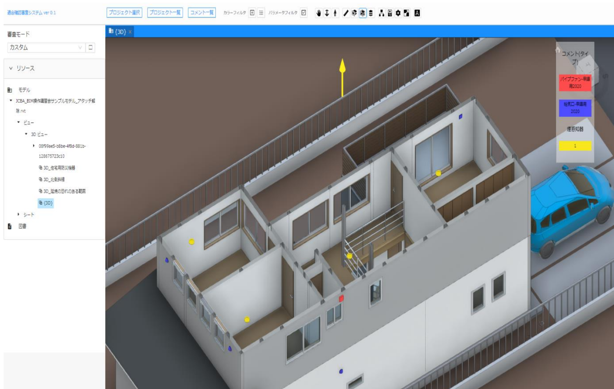
図11－住宅用防災機器をカラーフィルタにて色塗り表示
