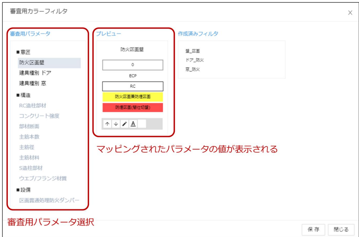
図5: マッピングしたパラメータのカラーフィルタ設定画面
